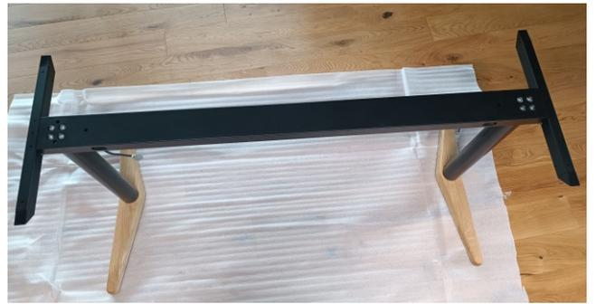
2. Montage der untere Holzfüße auf der Hubsäule (TM R70/3) mit je 4 Stk. mitgelieferte längste Schrauben (Linsenkopf M8×50) - siehe Bild 2. Der Holzfuß ist asymmetrisch, der lange Teil sieht nach vorne!
