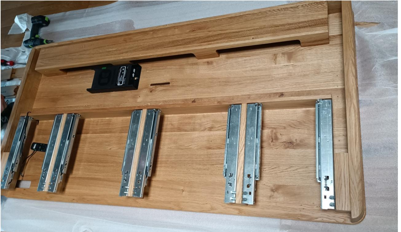
6. Drehen Sie die zusammengebaute Fußgestell um, und legen Sie ein der Tischplatte (2 man Arbeit!). Die Positionierung erfolgt durch die vorgebohrten Schraubenlöcher. Befestigen Sie das Untergestell mit dem 10 Stück mitgelieferte 3,5×16 mm Holzgewindeschrauben.
